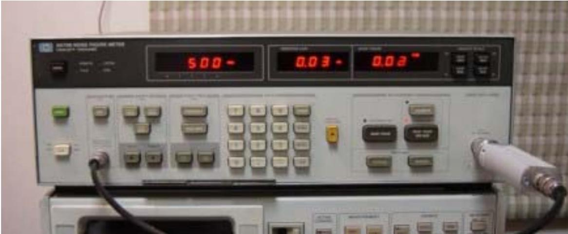
ENR値の設定と異なり、キャリブレーションはNFメータの電源を入れるたびに行なう必要が有ります（上写真のようにノイズソースを最短で入力に接続します）
