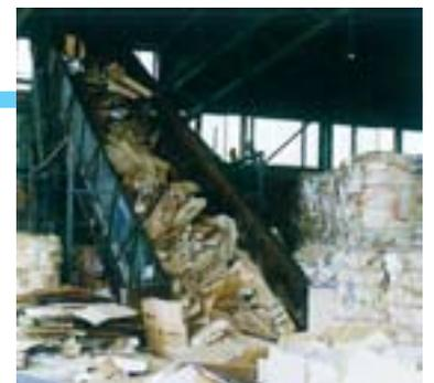
りません。品質維持のうえから他品種の古紙の混入には許容限度があり、中質紙、上質紙、印刷の有無、インクの種類などによって製紙工程で支障のないように分類する必要があります。印刷や紙加工技術の進歩により分類作業も複雑になっていますが、高度の熟練した技術と薬品による判別法などでの的確に対応しています。
